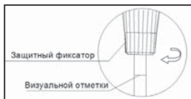
Рис.10a1. Для репозиционируемых стентов: сначала ослабьте защитный фиксатор, затем освободите часть стента, вытягивая переднюю ручку до визуальной отметки и удерживая заднюю ручку неподвижной. Рис.10a2. Вытяните переднюю ручку, чтобы полностью вынуть стент из системы установки.
