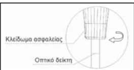
Εικόνα 19a1 Για τον ανασυρόμενο τύπο: χαλαρώστε πρώτα την κλειδαριά ασφαλείας, στη συνέχεια, ανασύρετε την μπροστινή λαβή μέχρι τον οπτικό δείκτη για να αναπτύξετε το στέντ ενώ ακινητοποιείτε την πίσω λαβή από την άλλη πλευρά.
