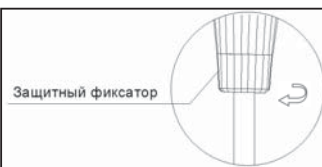
Рис.10b Для других типов: Сначала ослабьте защитный фиксатор. Затем, одной рукой удерживая заднюю ручку неподвижной, другой рукой медленно вытяните переднюю ручку.
