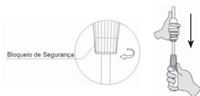
Fig.19b Para outros tipos: Em primeiro lugar, desbloqueie a trava de segurança. Depois, retraia a pega frontal com uma mão e implante o stent mantendo imobilizada a pega traseira.
